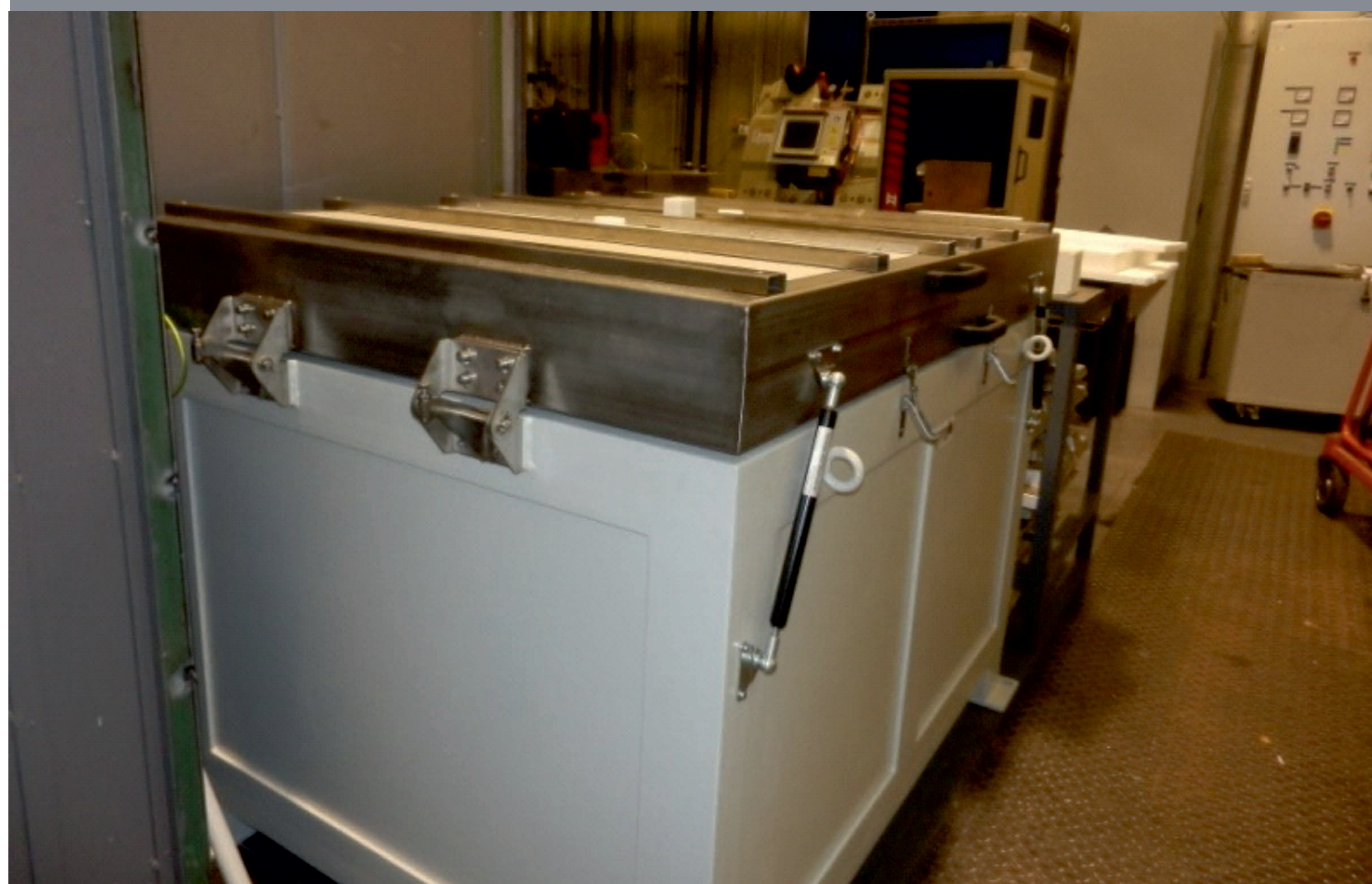
Foaming furnace HTM Reetz GmbH
